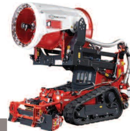
Il est propulsé par un moteur diesel de 20 ch et offre XNUMX heures de fonctionnement sur chaque réservoir, avec une lame de charrue fixée à l'avant au cas où des obstacles, tels que des voitures, doivent être retirés de son chemin.) aide à combattre les
